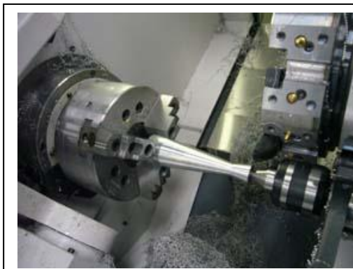
加工の様子（外丸削り・テーパ削り）
