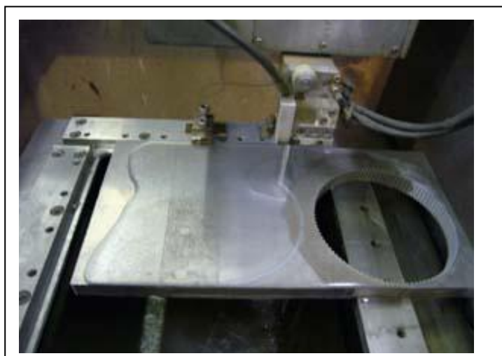
ワイヤカット放電加工機、加工の様子
