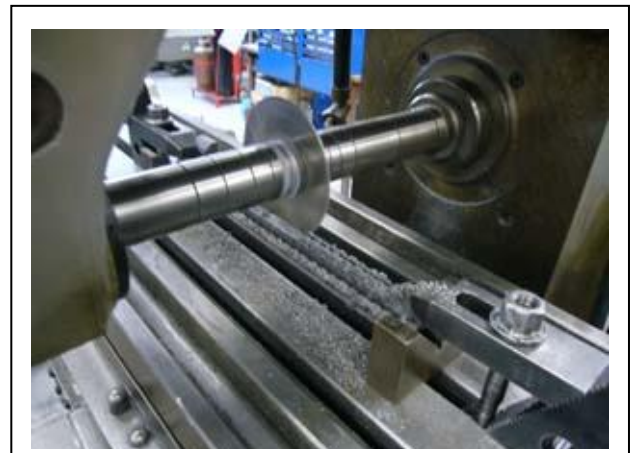
横フライス盤、加工の様子 (メタルソーによるスリット加工)
