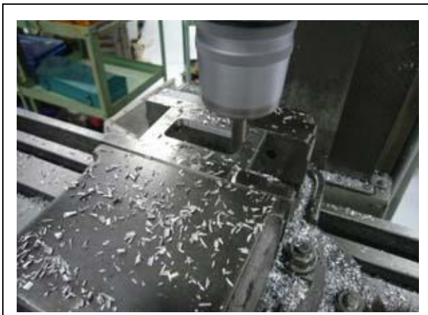
立フライス盤、加工の様子 (エンドミルによるポケット加工)
